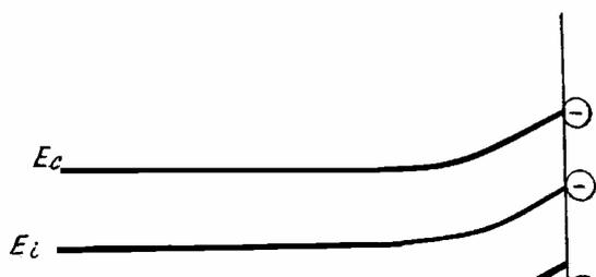
Рис. 57 Изгиб зон у поверхности полупроводника *n*-типа при отрицательном заряде поверхности
