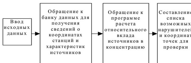
Рис. 1. Схема идентификации источников выброса
