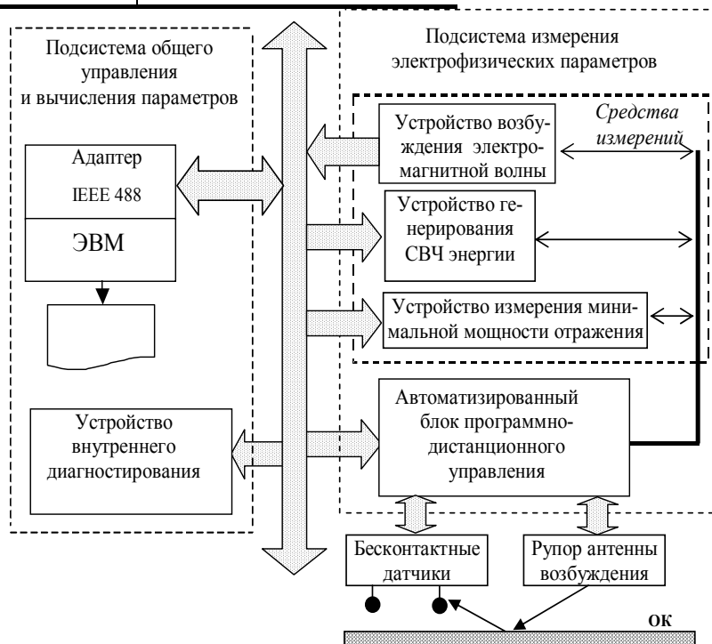
Рис. 4.20. Структурная схема автоматизированной системы контроля защитных покрытий
