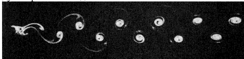
Рис. 2.13. Вихревая дорожка Кармана в воде, идущая слева направо за цилиндром при Re = 105 [36]
