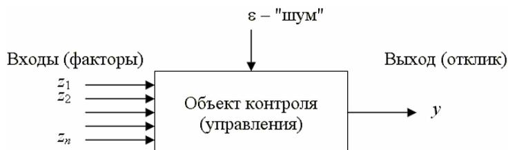
**Рис. 1** Схема объекта контроля (управления)
