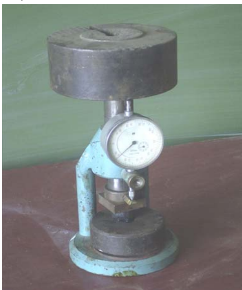
Рис. 3 Установка для испытаний на сжатие (a); б) схема нагружения образца при сжатии (б)
