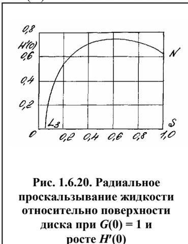
Рис. 1.6.20. Радиальное проскальзывание жидкости относительно поверхности диска при  $G(0) = 1$  и росте  $H'(0)$
