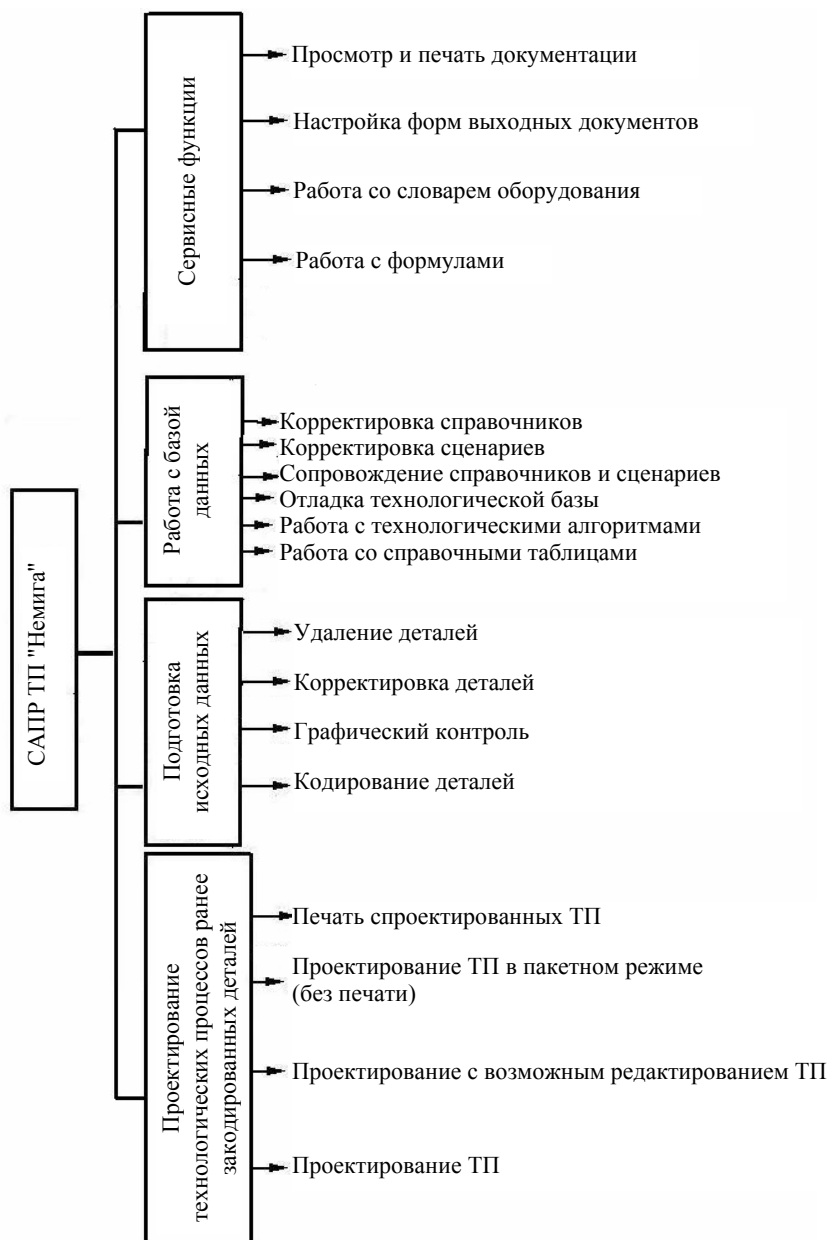
Рис. 1 Функциональная схема САПР ТП «Немига»
