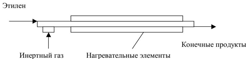
**Рис. 1.4. Схема трубчатого реактора разложения этилена**
