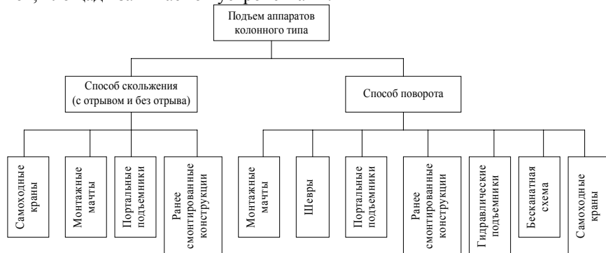
Рис. 32. Классификация основных способов и средств монтажа аппаратов колонного типа
