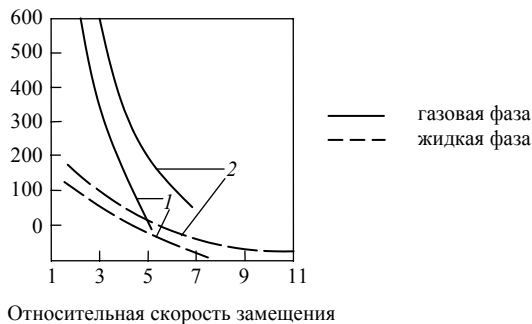
Рис. 2. Температурная зависимость относительной скорости замещения различных атомов водорода при хлорировании парафинов:
