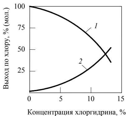
Рис. 12. Зависимость выхода хлоргидрина (1) и дихлорида (2) при хлоргидринировании этилена от концентрации хлоргидрина в растворе
