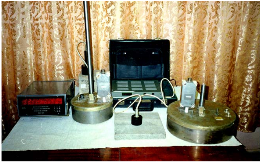
Рис. 2.15. Микропроцессорная система НК ТФС трехслойных строительных конструкций с использованием комбинации контактного и бесконтактного тепловых воздействий на исследуемый объект
