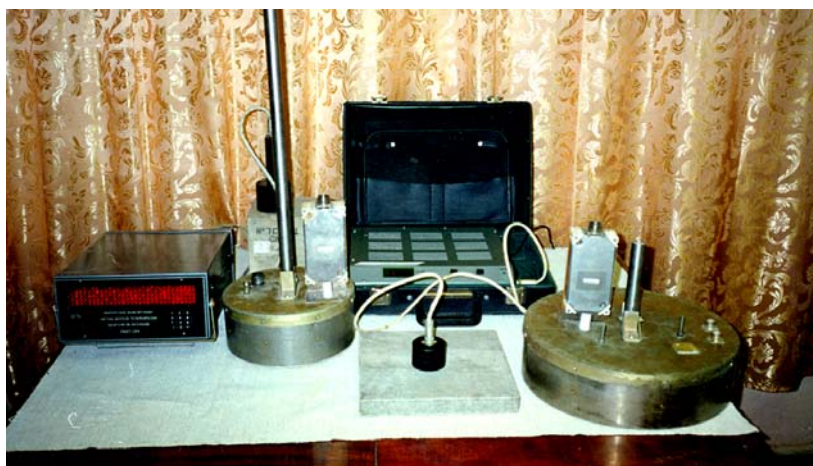
Рис. 4.5.5. Микропроцессорная система НК ТФС трехслойных строительных конструкций с использованием комбинации контактного и бесконтактного тепловых воздействий на исследуемый объект
