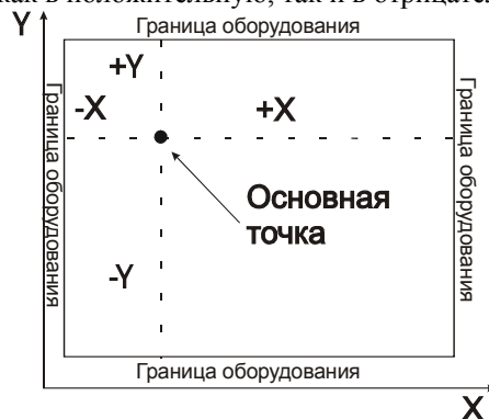
Рис. 7.5. Определение габаритов аппарата в пространстве относительно базовой точки (в плоскости XOY).
