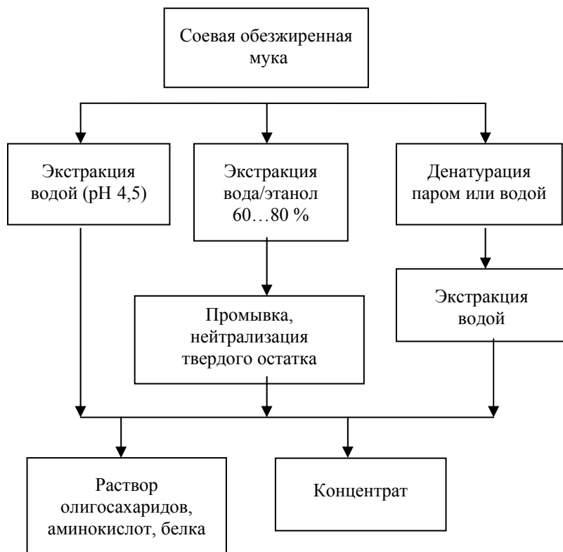
Рис. 2.9. Схема производства соевых белковых концентратов
