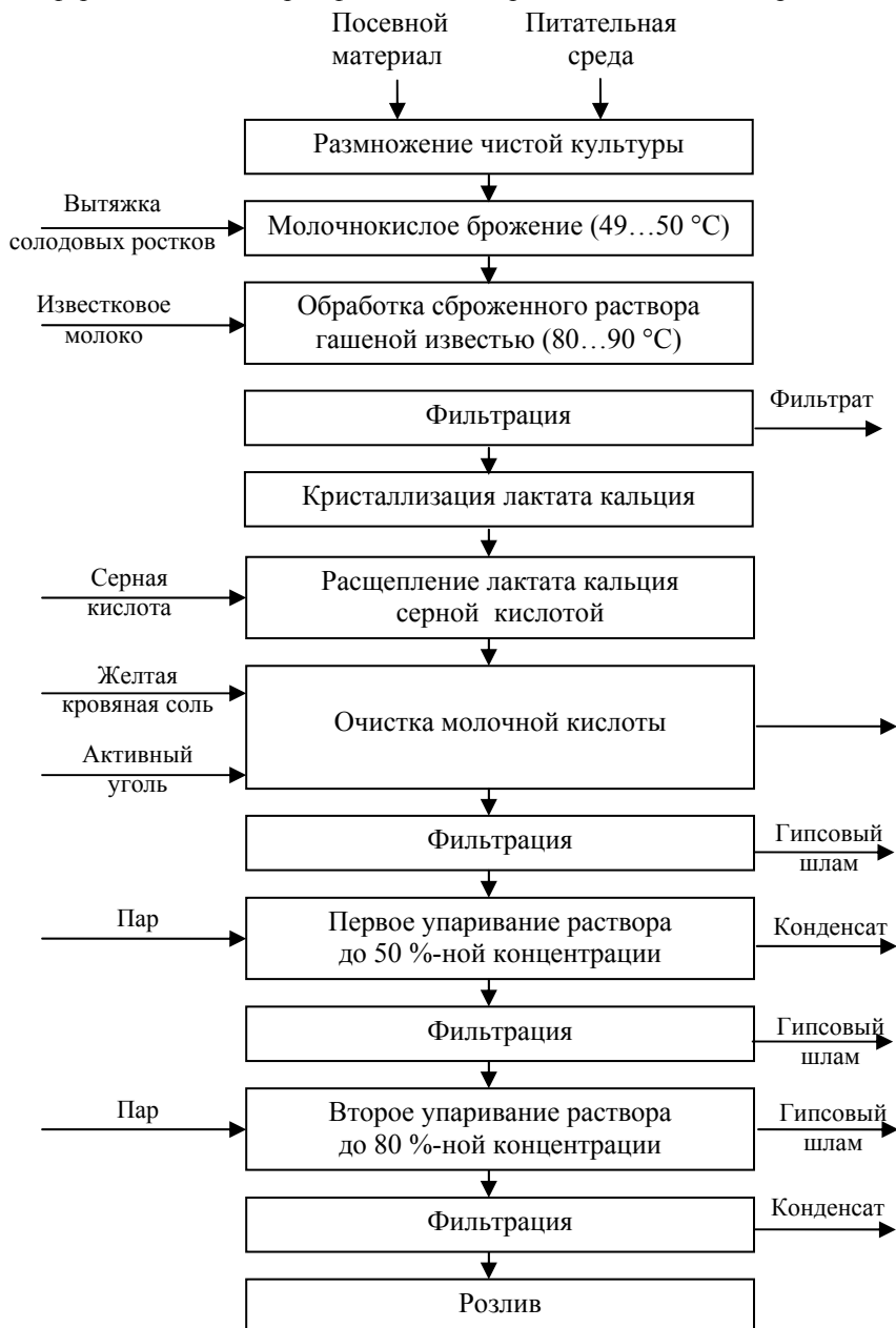
Рис. 1.2. Схема производства молочной кислоты
