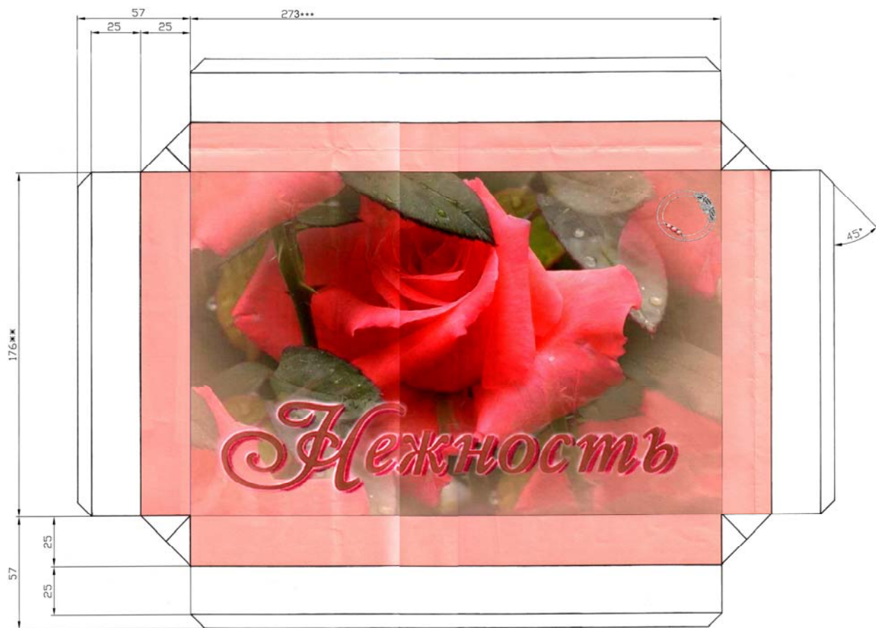
Рис. Д.6. Пример дизайнерской разработки коробки (раскрой)
