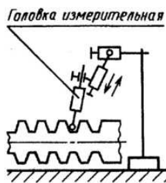
Рис. 35. Схема контроля профиля резьбы
