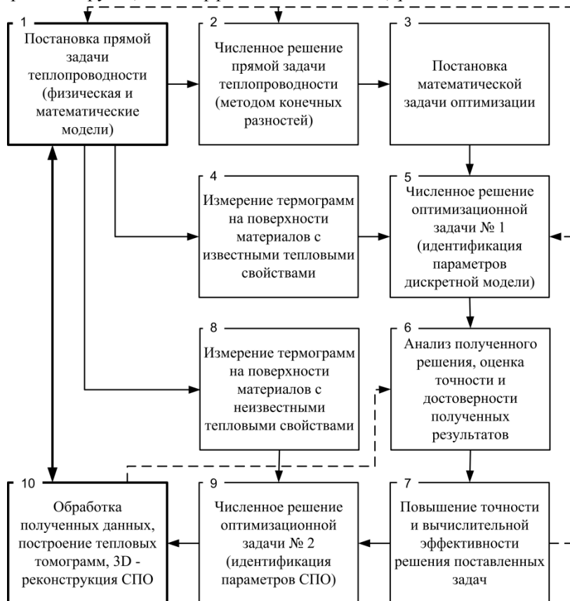
Рис. 1.4. Этапы методики обработки изображений в ИК-диапазоне волн
