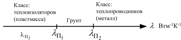
Рис. 1.8. Шкала классификации материалов по теплопроводности
