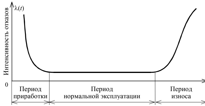
Рис. 2 Интенсивность отказов в течение срока службы изделия Надежность в период нормальной эксплуатации. Экспоненциальный закон распределения
