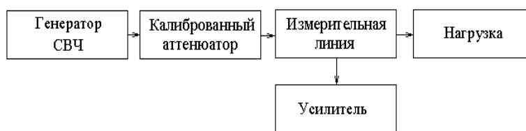
Рис. 1.5. Структурная схема лабораторной установки
