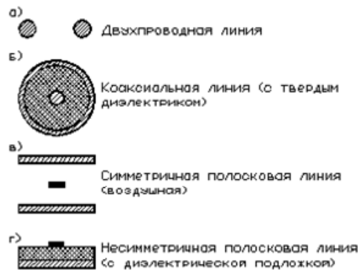
Рис. 1.1. Поперечные сечения длинных линий
