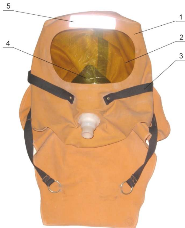
Рис. 27. Защитный колпак самоспасателя СПИ-20: 1 – колпак; 2 – смотровое окно; 3 – утяжник; 4 – полумаска; 5 – световозвращающая полоса
