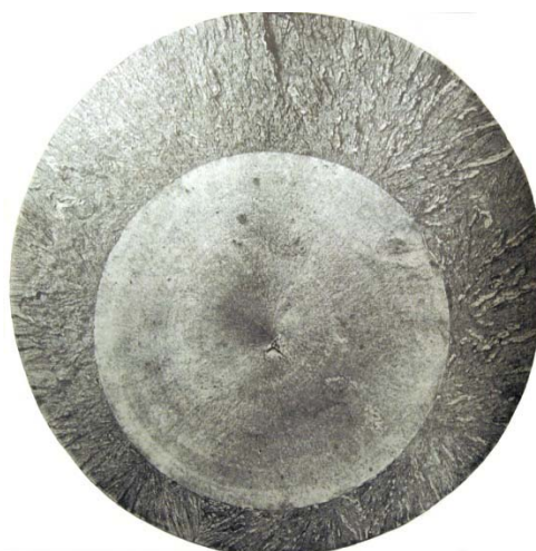
Рис. 10. Усталостное разрушение стержня поршня (зародыш – ковочная трещина)
