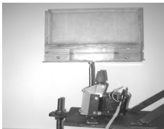
Рис. 5.16. Установка для исследования характера изменения потенциальной энергии порции сыпучего материала
