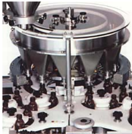
Рис. 2.15. Порционный дозатор роторного типа
