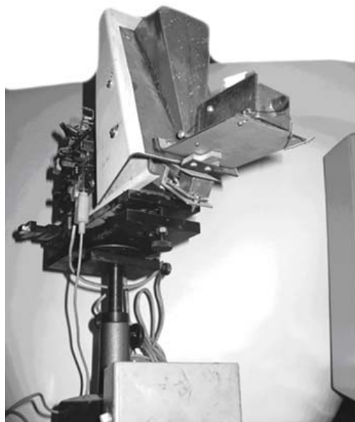
Рис. 4.27. Экспериментальная установка для непрерывного весового дозирования зернистых материалов
