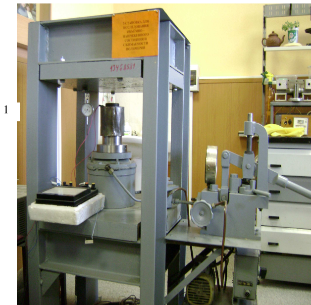
Рис. 3.11. Общий вид лабораторной установки для исследования объёмного напряжённо-деформированного состояния полимеров [2]
