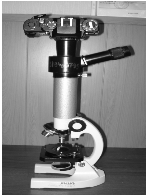
Рис. 4.7. Установка для макросъёмки экструдатов с координатной сеткой после ТФЭ
