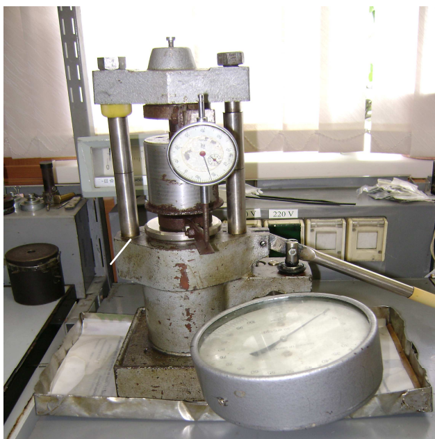
Рис. 4.1. Лабораторная установка на базе гидравлического пресса, усилием 4 тс:
