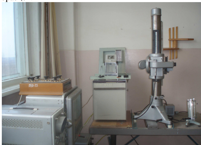
Рис. 7.18. Лабораторная установка для определения диффузионных свойств материалов
