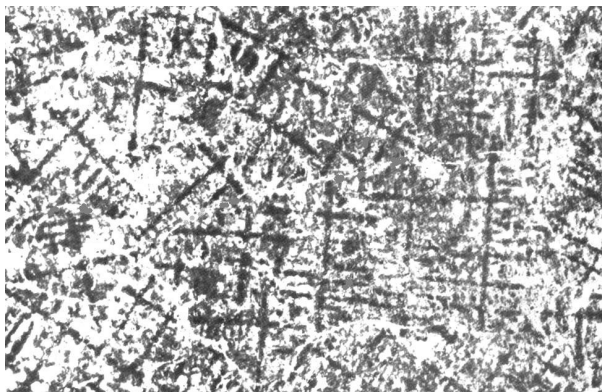
Рис. 4. Дендритная структура стального проката
