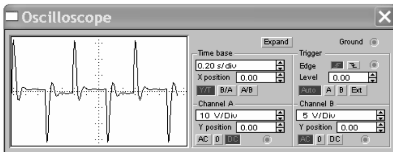
Рис. 16. Переходный процесс в цепи с двумя накопителями энергии Контрольные вопросы
