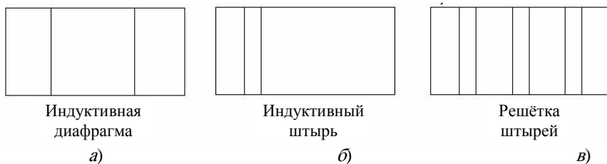
Рис. 1.5. Взаимные, реактивные, симметричные и симметрично рассеивающие препятствия
