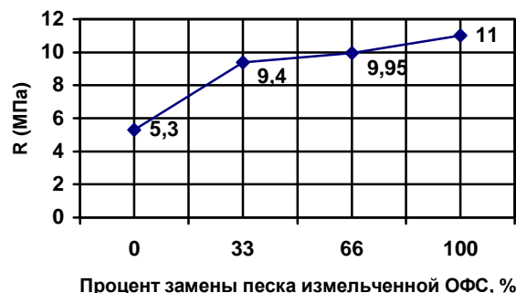
Рис. 1. Зависимость прочности на сжатие от процента замены песка измельченными ОФС
