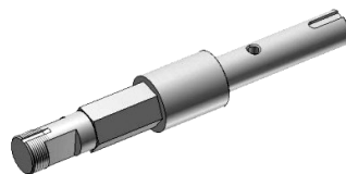
Рис. 3.38. Изометрическое изображение вала
