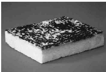
Рис. 52. Удаление покрытия крыши для изучения состояния панелей из пенопласта, установленных 31 год назад (а); образец, взятый с плоской крыши (б)
