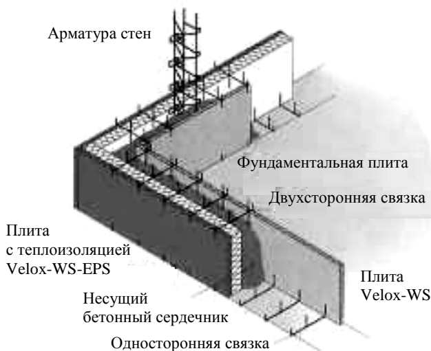
Рис. 26. Технология бетонирования в несъемной опалубке фирмы "Velox"
