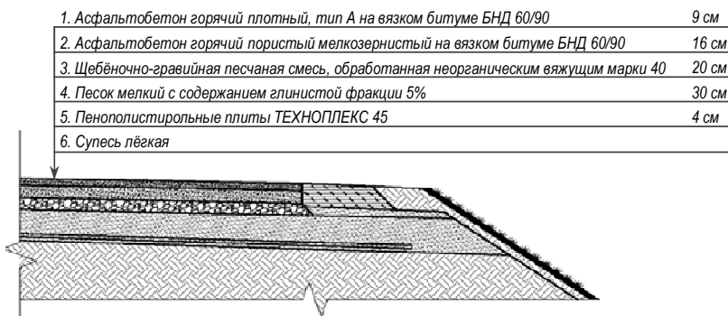
Рис. 61. Конструкция нежёсткой дорожной одежды с применением экструзионного пенополистирола ТЕХНОПЛЕКС 45 для дороги III категории
