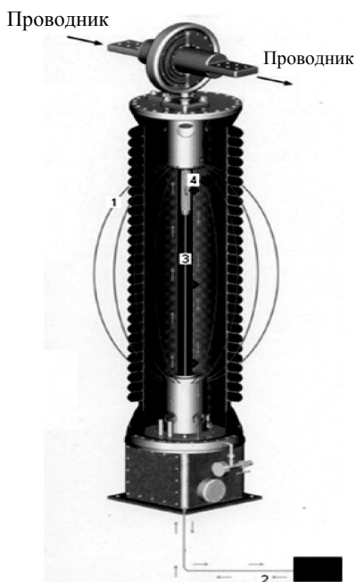
Рис. 2.9. Конструкция оптического высоковольтного измерительного трансформатора напряжения
