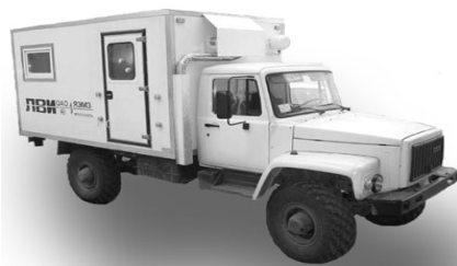
Рис. 2.18. Передвижная электролаборатория ЛВИ-НВТ (35 кВ)
