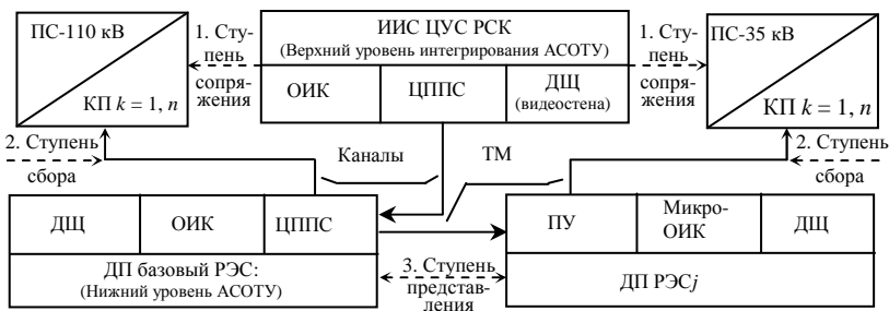
Рис. 1.3. Структура двухуровневой ИИС РСК «Тамбовэнерго»
