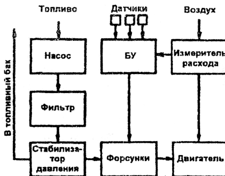
Рис. 4.9. Структурная блок-схема системы впрыска топлива с программным управлением
