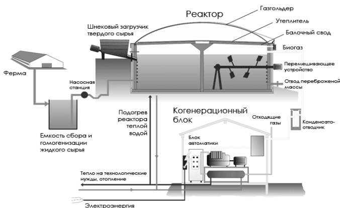
Рис. 17. Схема биогазовой установки
