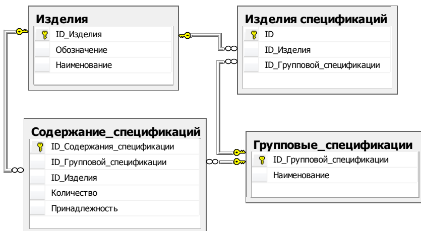
Рис. 7.4. Структура базы данных групповых спецификаций с полем принадлежности
