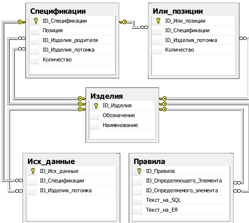
Рис. 7.8. Структура базы данных спецификации изделий с взаимозаменяемыми элементами
