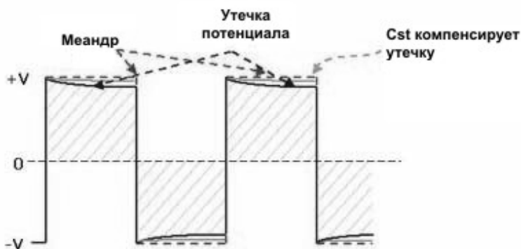
Рис. 32. Компенсирующее действие запоминающего конденсатора
