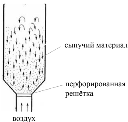
Рис. 4. Сыпучие материалы в состоянии псевдооживления
