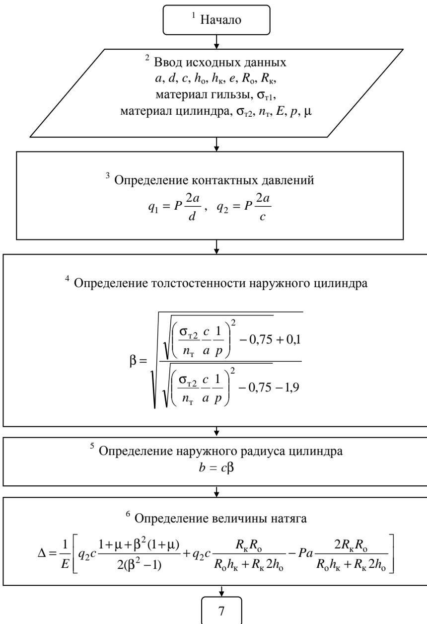
Рис. 2.7. Блок-схема алгоритма расчёта на прочность составного цилиндра с винтовой канавкой в месте сопряжения
