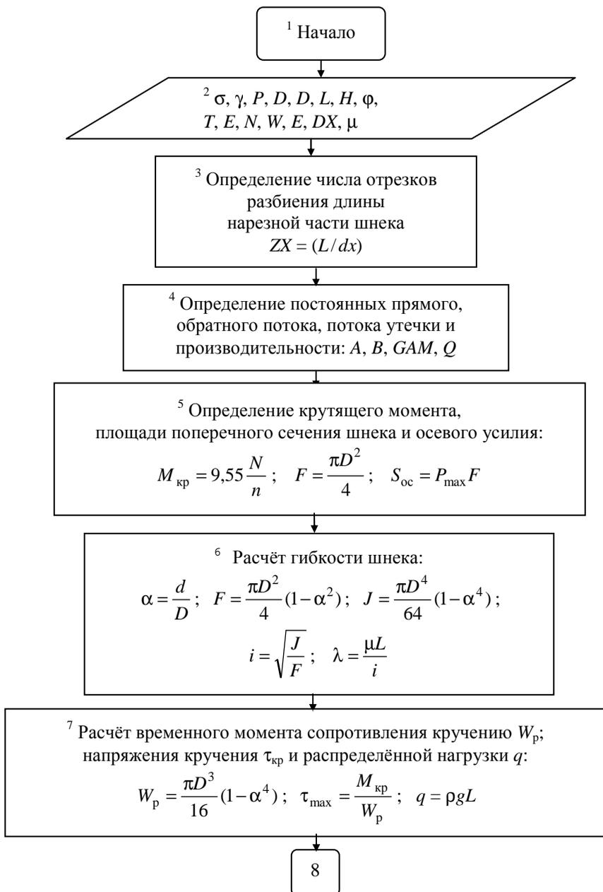
**Рис. 1.2.** Блок-схема алгоритма расчёта консольного шнека на прочность и жёсткость
