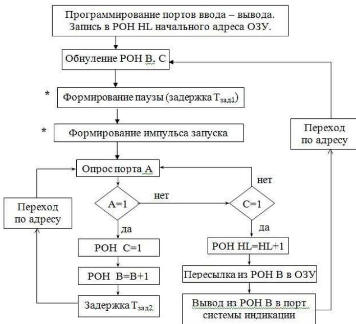
**Рис. 4.7. Типовой алгоритм работы МК**
