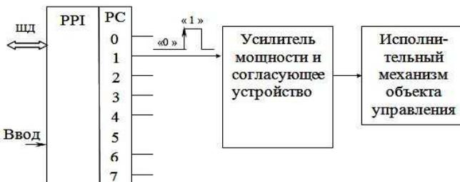
**Рис. 4.14.** Схема подключения исполнительного устройства
