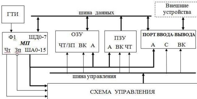
Рис. 4.4. Функциональная схема МПС
