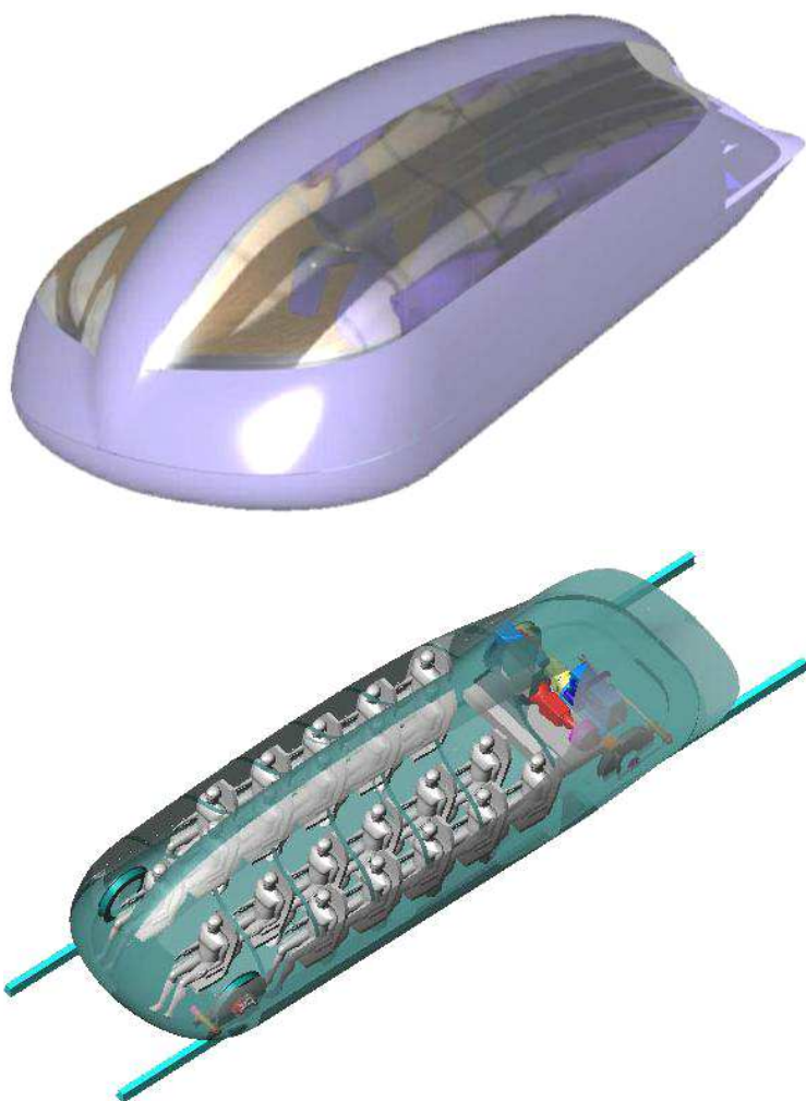
Рис. 10. Высокоскоростной пассажирский транспортный модуль. Пассажировместимость – до 50 человек, максимальная скорость 500 км/ч
