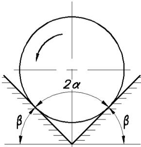
**Д2.15** (МАТИ, 1981). Тяжёлый маховик радиусом  $R$  раскрутили до угловой скорости  $\omega_0$  и поместили между двумя стенками, расположенными под углом  $2\alpha$  одна к другой. Коэффициент трения между маховиком и стенками равен  $f$ . Углы между стенками и горизонтальной плоскостью одинаковы. Масса маховика распределена по ободу. Определить число оборотов  $n$  маховика до его остановки.
