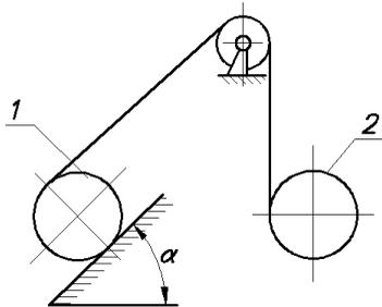
**Д9.3** (Свердловск, 1982). Два одинаковых однородных цилиндра  $1$  и  $2$  весом  $P$  и радиусом  $R$  соединены невесомой нитью, переброшенной через невесомый блок; концы нити намотаны на цилиндры. Система движется под действием сил веса. Цилиндр  $1$  катится без скольжения по плоскости, наклонённой под углом  $\alpha$  к горизонту.
