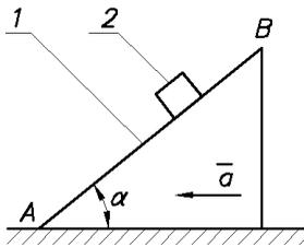
**Д3.5** (Свердловск, 1983). С каким ускорением  $a$  должна двигаться призма  $1$  с острым углом  $\alpha$ , чтобы груз  $2$  поднимался вверх по  $AB$ ? Коэффициент трения груза о призму равен  $f$  (движение начинается из состояния покоя).
