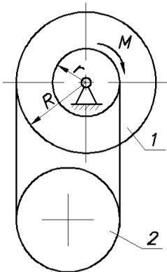
**Д3.7** (Свердловск, 1986). Механическая система состоит из ступенчатого барабана  $1$ , однородного диска  $2$  и гибкой нерастяжимой нити.
