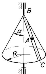
Определить относительное ускорение шарика в момент, когда он достигает основания конуса. Трением пренебречь.
