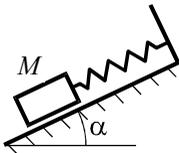
2. Груз  $M$  массой  $m$  помещён на негладкую наклонную плоскость, образующую с горизонтом угол  $\alpha$ , и прикреплён к концу пружины с коэффициентом жёсткости  $s$ , другой конец которой закреплён неподвижно. Определить максимальное растяжение пружины  $\Delta l$ , если в начальный момент пружина была не деформирована, а груз опущен без начальной скорости. Коэффициент трения тела о плоскость равен  $f$ , причём  $f < \text{tg} \alpha$ .
