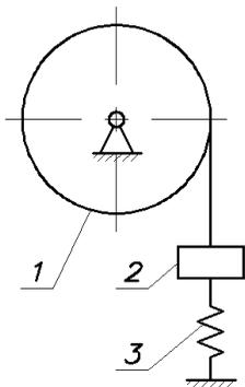
**Д9.4** (Омск. политех. ин-т, 1984). На однородный диск  $1$  радиусом  $R$  с неподвижной осью вращения намотана нить с грузом  $2$  на конце. К грузу снизу прикреплена пружина  $3$ . Массы диска и груза равны  $m_1$  и  $m_2$ , жёсткость пружины  $c$ . Диск повернули против хода часовой стрелки так, что пружина получила удлинение  $\lambda$ , и отпустили без начальной скорости.
