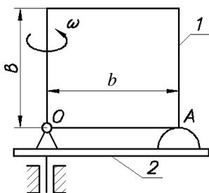
**Д2.24** (Омск. политех. ин-т, 1986). Однородная пластинка  $l$  весом  $P$ , расположенная в вертикальной плоскости, закреплена в точке  $O$  шарниром, а в точке  $A$  свободно опирается на выступ платформы 2. Платформа вращается вокруг вертикальной оси с постоянной угловой скоростью.
