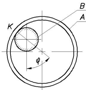
**Д2.35** (МВТУ, 1980). Тонкое однородное кольцо  $A$  весом  $P$  движется в вертикальной плоскости, перекатываясь без скольжения по неподвижному цилиндрическому валу  $B$ . Ось вала  $B$  – горизонтальна. Определить силу трения в контактной точке  $K$  в зависимости от её положения.
