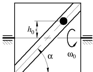
**Д1.7** (МАТИ, 1981). Гладкая трубка расположена по диагонали прямоугольной рамки, вращающейся с постоянной угловой скоростью  $\omega_0$  вокруг своей горизонтальной оси симметрии. Угол между осью вращения и трубкой равен  $\alpha$ . В трубке на расстоянии  $h_0$  от
