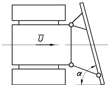
$\mu = \text{const} > 0$ ,  $\bar{V}$  – абсолютная скорость камня. Коэффициент трения скольжения между камнем и ножом равен  $f$ ;  $f < \text{ctg} \alpha$ .
