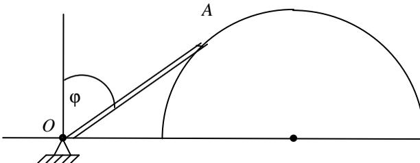
угле  $\varphi = \pi/4$ . Найти скорость и ускорение полуцилиндра и реакцию  $N$  полуцилиндра в точке  $A$  в тот момент, когда его скорость равна по модулю скорости точки  $A$ . Трение не учитывать.
