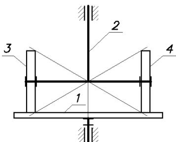
**Д2.7** (Поволжск. зона, 1986). Во фрикционном механизме диск  $1$  за каждую секунду совершает 1 оборот, а водило  $2$  вращается вдвое медленнее. Определить кинетическую энергию ролика  $3$  (или  $4$ ), считая ролик диском массой  $m$  и радиусом  $r$ . Скользянием пренебречь.
