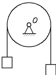
**Д3.14** (Гамб. ин-т хим. машиностр., 1988). На шкив, вращающийся без сопротивления вокруг горизонтальной оси  $O$  с угловой скоростью  $\omega_0$ , накинута длинный ремень с двумя грузами на концах. Шкив – однородный диск массой  $m$  и радиусом  $r$ , масса каждого из грузов  $M = 2m$ .
