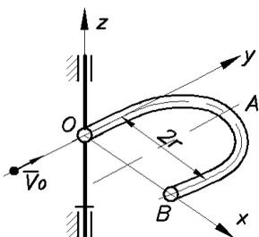
Д8.5 (Молд. ССР, 1982). Гладкий шарик массой  $m = 5$  кг запускают в точке  $O$  со скоростью  $V_0 = 3$  м/с в покоящуюся горизонтально расположенную изогнутую трубку  $OAB$ , прикрепленную к вертикальной оси. Момент инерции трубки относительно оси вращения  $J = 40$  кг·м<sup>2</sup>,  $r = 4$  м.
