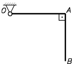
**Д4.6** (Тамб. ин-т хим. машиностр., 1987). Угольник  $OAB$ , состоящий из двух тонких однородных стержней массой  $m$  и длиной  $l$  каждый, отпущен без начальной скорости из положения, указанного на рисунке, и движется в вертикальной плоскости под действием сил тяжести.
