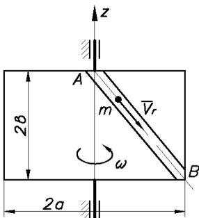
Д8.6 (Тамб. ин-т хим. машиностр., 1986). Прямоугольная однородная пластинка массой  $m$  вращается по инерции с угловой скоростью  $\omega_0$  вокруг вертикальной оси  $z$ , лежащей в её плоскости и проходящей через центр масс пластины. В некоторый момент времени из точки  $A$ , расположенной на оси  $z$ , начинает опускаться по желобу  $AB$  материальная точка массы  $m$ . Определить скорость  $V_r$  точки относительно пластины в тот момент времени, когда точка достигнет положения  $B$ .
