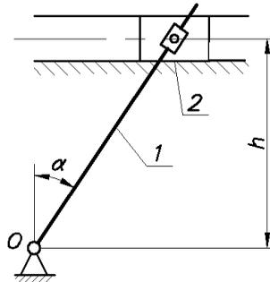
вертикального положения. Расстояние от оси вращения стержня  $O$  до оси паза  $h = 0,9$  м. Рассеянием энергии за счёт сил трения пренебречь.
