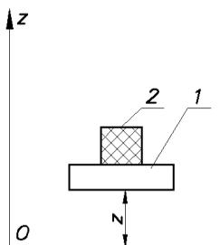
**Д10.11** (Омск. политех. ин-т, 1983). Платформа 1 движется поступательно по вертикали. Закон движения платформы:  $z = b \cos \omega t$ . Здесь  $\omega$  – круговая частота. На платформу положен кубик массой  $m$ . Определить частоту  $\omega$ , при которой кубик начнет отделяться от платформы (подпрыгивать).
