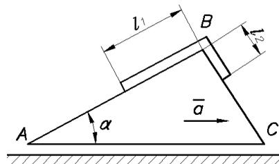
клин начинают двигать с постоянным ускорением  $a$ . Найти ускорение  $a_c$  цепочки по отношению к клину в начальный момент времени. При вычислениях принять  $a = 0,5g$ . Трение не учитывать.
