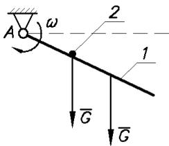
Д3.21 (Омск. политех. ин-т, 1981). Однородный стержень  $l$  длиной  $b$  шарнирно закреплён в точке  $A$ . От точки  $A$  по стержню начинает двигаться материальная точка  $2$ , масса  $m$  которой равна массе стержня. В начальный момент стержень занимал горизонтальное положение; получив толчок, он начал вращаться в вертикальной плоскости по часовой стрелке.
