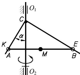
При какой угловой скорости вращения конструкции стержень \$KE\$ займёт горизонтальное положение?
