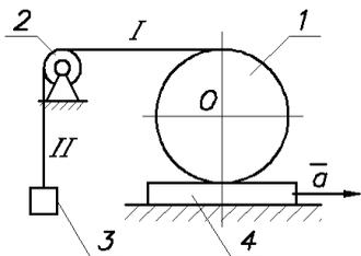
**Д3.29** (Тамб. ин-т хим. машиностр., 1978). Массы тел \$1, 2\$ и \$3\$ соответственно равны \$m\_1, m\_2\$ и \$m\_3\$, причём тела \$1\$ и \$2\$ – однородные диски. Диск \$1\$ катится по бруску \$4\$ без скольжения, а брусок движется с постоянным ускорением \$a\$ вправо. Определить ускорение \$a\_r\$ центра \$O\$ диска \$1\$ по отношению к телу \$4\$ и натяжение нити на участках I и II.
