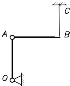
**Д7.11** (Тамб. ин-т хим. машиностр., 1977). Два одинаковых однородных стержня  $OA$  и  $AB$  длиной  $b$  каждый соединены между собой шарнирно и могут перемещаться в вертикальной плоскости. Конец  $O$  стержня  $OA$  закреплён шарнирно, а конец  $B$  стержня  $AB$  поддерживается
