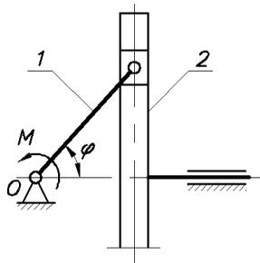
Д3.23 (Омск. политех. ин-т, 1988). К кривошипу  $l$  механизма, расположенного в горизонтальной плоскости, применён постоянный момент  $M$ , при движении кулисы  $2$  возникает постоянная по величине сила сопротивления  $F$ . Движение начинается из состояния покоя в положении, когда  $\varphi = 0$ . Кривошип – однородный стержень длиной  $l$ , известны массы кривошипа и кулисы.
