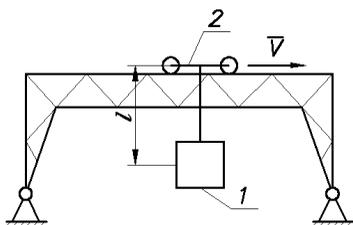
**Д10.12** (Омск. политех. ин-т, 1984). Груз 1 перемещается вместе с тележкой 2 по горизонтальной ферме мостового крана со скоростью  $V$ . Расстояние от центра тяжести груза до точки привеса равно  $l$ . При внезапной остановке тележки груз по инерции будет продолжать движение и начнёт качаться около точки привеса. Определить наибольшее натяжение троса и наибольшую высоту подъёма груза.
