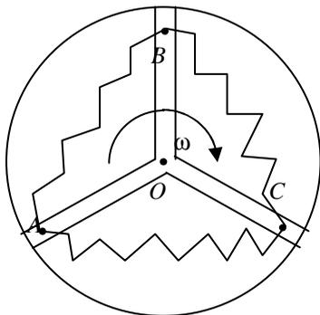
**Задача Д1-95** (4 балла). На диске имеются три симметрично расположенных паза, в которых находятся материальные точки  $A, B, C$  массой  $m$  каждая, соединённые друг с другом одинаковыми пружинами жёсткостью  $c$ . Система находится в горизонтальной плоскости, длина недеформированной пружины  $l$ , трение не учитывается. Диск вращается с некоторой постоянной угловой скоростью  $\omega$  вокруг оси  $O$ .
