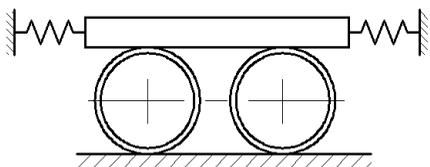
скольжение между доской и цилиндрами, а также между цилиндрами и горизонтальной плоскостью отсутствует. Определить период колебаний системы, если масса каждого цилиндра равна  $m$ , а масса доски  $M$ .
