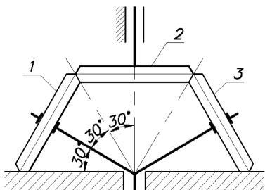
**Д10.10** (Тольяттинск. политех. ин-т, 1986). Фрикционный механизм состоит из трёх одинаковых роликов (дисков) массой  $m$  и радиусом  $r$ . Ролики 1 и 3 меняются местами каждую секунду. Определить суммарную кинетическую энергию роликов.
