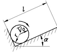
Определить движение цилиндра после отрыва его от опоры. Указать условие, при котором такое движение возможно.
