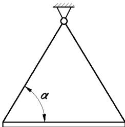
**Д6.5** (Гамб. ин-т хим. машиностр., 1989). Однородный стержень весом  $P$  подвешен в горизонтальном положении на двух нитях,  $\alpha = 60^\circ$ . Найти натяжение одной из нитей в первый момент после перерезания другой.
