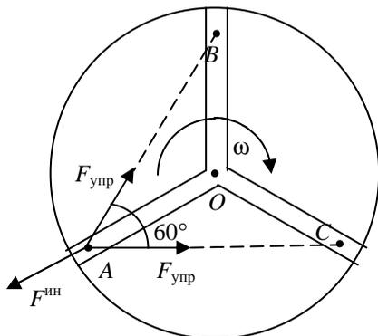
Согласно принципа Даламбера, на каждую материальную точку действуют в горизонтальной плоскости силы инерции и упругости пружин:
