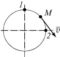
3. Материальная точка  $M$  массой 1 кг равномерно движется по окружности со скоростью  $v = 4$  м/с. Определить импульс равнодействующей всех сил, действующих на эту точку, за время её движения из положения 1 в положение 2.
