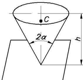
**Д2.36** (Тамб. ин-т хим. машиностр., 1986). Однородный прямоугольный конус высотой  $h$  с углом  $2\alpha$  при вершине поставлен вершиной на гладкую горизонтальную плоскость. Найти расстояние  $S$ , на которое переместится вершина конуса к моменту его падения на плоскость. Определить также скорость центра тяжести  $C$  конуса в момент его падения на плоскость.
