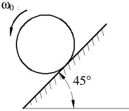
**Д2.14** (М., 1988). Однородный обруч радиусом  $r = 1$  м, которому сообщена угловая скорость  $\omega_0 = 5\sqrt{2}$ , рад/с, поставлен на наклонную плоскость и предоставлен самому себе. Коэффициент трения обруча о плоскость  $f$ . Определить дальнейшее движение обруча, считая его плоским. (Трением качения пренебречь, принять  $g = 10$  м/с<sup>2</sup>).
