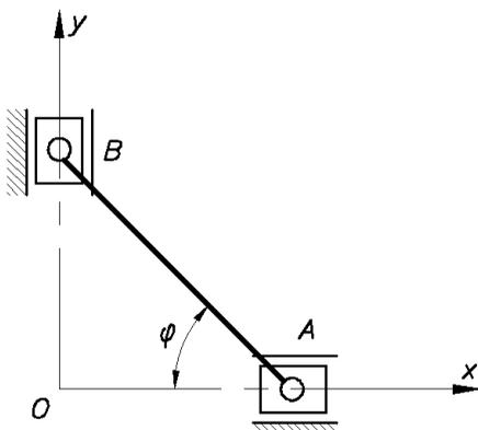
**Д3.13** (Брянск. ин-т трансп. порт. машиностр.). Два ползуна  $A$  и  $B$ , имеющие одинаковый вес  $P$  и связанные невесомым стержнем  $AB$ , могут скользить без трения соответственно вдоль осей  $Ox$  и  $Oy$ . В начальный момент времени система находилась в покое, а  $\varphi_0 = \pi/3$ . Определить усилие  $S$  в стержне  $AB$  в тот момент, когда  $\varphi = \pi/6$ .
