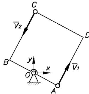
Определить давление пластины на ось  $OZ$  для указанного на рисунке положения, пренебрегая массой пластины и трением в шарнире, если  $AO = OB = l$ . В начальный момент времени система находилась в покое.
