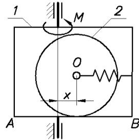
Составить дифференциальные уравнения движения механической системы, приняв за обобщённые координаты угол  $\varphi$  поворота рамы и координату  $x$  центра диска.
