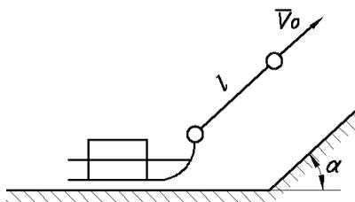
**Д2.21** (Зап.-Сиб. зона, 1990). Человек поднимается в гору с углом подъёма  $\alpha$  с постоянной скоростью  $V_0$  и тянет за собой на жёсткой тяге длиной  $l$  сани массой  $m$ , находящиеся на горизонтальном участке дороги. Найти натяжение тяги в тот момент, когда она составит угол  $\alpha$  с горизонтом. Трением саней о поверхность дороги пренебречь.
