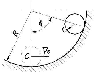
**Д2.37** (Тамб. ин-т хим. машиностр., 1989). Однородный цилиндр радиусом  $r$  находился в нижнем положении внутри цилиндрической полости радиусом  $R$  с горизонтальной образующей. Из этого положения цилиндру сообщили плоское движение без скольжения с начальной скоростью оси  $C$   $V_0 = \sqrt{\frac{4}{3}(R-r)g}$ .
