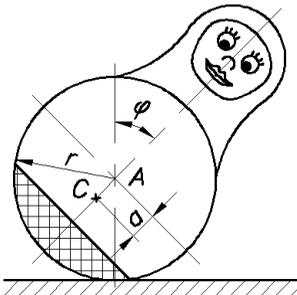
Д7.3 (Поволжск. зона, 1986). «Неваляшка» массой  $m$  с центром тяжести в точке  $C$  и моментом инерции  $J_A = mi_A^2$  качается на идеально гладкой горизонтальной плоскости. Определить период малых колебаний около положения равновесия.
