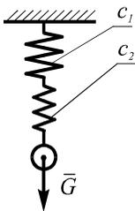
5. Груз подвешен на двух последовательно соединённых пружинах с коэффициентами жёсткости  $c_1$  и  $c_2$ . Каково отношение потенциальных энергий пружин?
