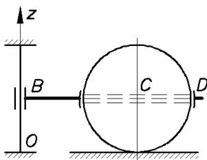
**Д2.30** (Тамб. ин-т хим. машиностр., 1983). Тяжёлый однородный шар связан с вертикальной осью тонким невесомым стержнем  $BD$ , относительно которого шар может вращаться. Длина стержня  $BD$ , перпендикулярного оси  $OZ$ , в три раза превышает радиус шара. Какую начальную горизонтальную скорость  $V$  перпендикулярно
