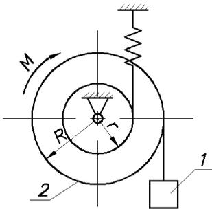
Д7.2 (Свердловск, 1983). Механическая система содержит груз  $1$  весом  $P = 100$  Н, ступенчатый блок  $2$  весом  $Q = 50$  Н с радиусом инерции  $i = 2$  м и невесомую пружину с коэффициентом жёсткости  $c = 2000$  Н/м. Система находится в покое под действием упругой силы пружины, силы тяжести и момента  $M = 200$  Н·м. Система приходит в движение вследствие того, что момент мгновенно исчезает ( $M = 0$ ).
