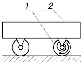
**Д10.5** (Омск. политех. ин-т, 1988). Спиральная пружина жёсткости  $c$  одним концом прикреплена к колесу 1, другим – к корпусу тележки 2. Тележку после закручивания пружины на угол  $\varphi_0$  поставили на пол и отпустили без начальной скорости. Пружина, раскручиваясь, приводит тележку в движение. Колёса (четыре однородных диска) катятся по полу без скольжения.
