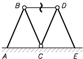
**Д6.6** (Груз. ССР, 1986). «Гармошка»  $ABCDE$  из четырёх шарнирно закреплённых однородных стержней длиной  $l$  и массой  $m$  каждый стоит на гладком горизонтальном полу и удерживается в равновесии стяжкой  $BD$ . После разрыва стяжки гармошка начинает падать.
