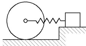
Определить скорость центра цилиндра в тот момент, когда пружина сожмётся до первоначальной длины. Трением качения пренебречь.
