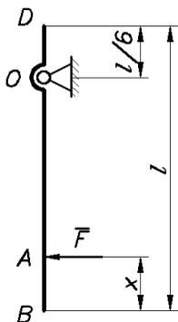
**Д6.7** (Свердловск, 1983). Однородный стержень длиной  $l$  и весом  $P$  свободно подвешен на горизонтальной оси  $O$  ( $OD = l/6$ ). В положении устойчивого равновесия к стержню в точке  $A$  прикладывают силу  $F$ .
