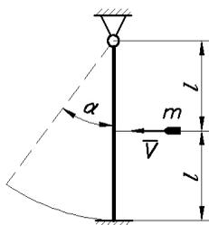
**Д5.2** (Тольяттинск. политех. ин-т, 1986). Пуля массой  $m$  попадает в центр висящей на петлях прямоугольной доски и застревает в ней. Доска массой  $M$  и длиной  $2l$  от удара отклоняется на угол  $\alpha$ . Определить скорость  $V$  пули. Трением в петлях и сопротивлением воздуха пренебречь.
