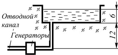
4. Водохранилище при гидростанции имеет площадь  $2 \text{ км}^2$  и глубину 6 м. Дно водохранилища лежит на высоте 12 м выше уровня воды в отводном канале за гидростанцией. Определить работу, которую может совершить сила тяжести запасённой в водохранилище воды.
