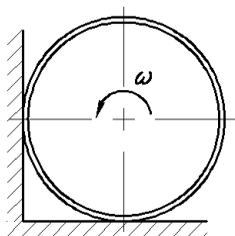
**Д2.23** (Омск. политех. ин-т, 1982). Тонкостенный цилиндр радиусом  $R$  раскрутили до скорости  $\omega$  и поставили в угол. Определить, сколько оборотов сделает цилиндр до остановки, вызванной трением о стенки с коэффициентом  $f$ .
