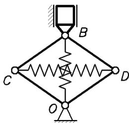
**Д3.28** (УССР, 1987). Ползун массой \$M\$, движущийся в вертикальном направлении в направляющих, связан с ромбом, образованным стержнями длиной \$l\$ и массой \$m\$. Пружина с коэффициентом жёсткости \$c\_1\$ связывает вершины \$C\$ и \$D\$, пружина с жёсткостью \$c\_2\$ связывает вершины \$O\$ и \$B\$. В положении равновесия углы между стержнями составляют \$90^\circ\$.
