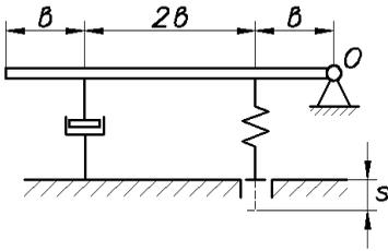
Д7.1 (Свердловск, 1982). Однородный стержень длиной  $l = 4b$  ( $b = 0,49$  м) и массой  $m = 30$  кг закреплён шарнирно в точке  $O$ . Стержень удерживается в равновесии в горизонтальном положении пружиной жёсткостью  $c = 78,4$  Н/см, прикрепленной к стержню на расстоянии  $b$  от опоры  $O$ . На расстоянии  $3b$  от опоры прикреплен гидравлический демпфер с линейно-вязким сопротивлением  $\bar{R} = -\mu\bar{V}$ ,  $\mu = 0,8$  Н с/см.
