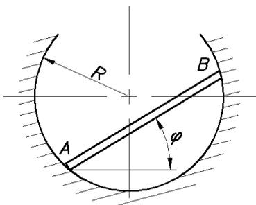
**Д7.10** (Свердловск, 1984). Тяжёлый однородный стержень массой  $m$  и длиной  $2l$  скользит по гладкой цилиндрической поверхности, оставаясь в вертикальной плоскости. Движение началось из состояния покоя в положении, определяемом углом  $\varphi = \varphi_0$  между стержнем и горизонтальной плоскостью.
