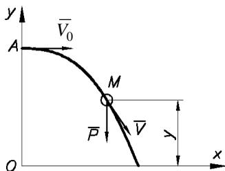
**Д1.8** (МИИТ, 1980). Гладкая проволока, изогнутая по параболе, уравнение которой имеет вид  $y = b - ax^2$ , расположена в вертикальной плоскости. Из вершины параболы  $A$  начинает перемещаться с начальной скоростью  $V_0$  кольцо  $M$  весом  $P$ .
