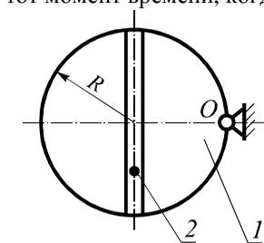
Д8.7 (Междунар. олимпиада, Гомель, 2005). Сплошной однородный диск  $I$  массой  $m_1$  и радиусом  $R$  расположен в горизонтальной плоскости и может вращаться вокруг вертикальной оси  $O$ . Силы сопротивления при этом пренебрежимо малы. Из центра покоящегося диска по расположенному вдоль его диаметра пазу начинает ползти жук  $2$  с постоянной относительной скоростью  $V_{отн}$ .
