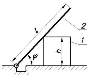
Д3.22 (Омск. политех. ин-т, 1982). Однородный тонкий стержень из состояния покоя опускается под действием собственного веса и приводит в движение по гладкой горизонтальной плоскости прямоугольный брусок.
