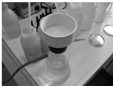
Рис. 35. Фильтрование суспензии под вакуумом: а – схема; 1 – воронка Бюхнера; 2 – колба Бунзена; б – лабораторная установка
