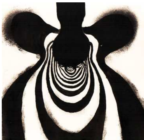
Рис. 10.15. Картина изохром при вдавливании в оптически активную пластинку:
