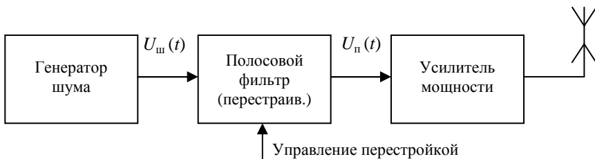
Рис. 2.13. Структурная схема устройства формирования ПППП прямым усилением шумового сигнала
