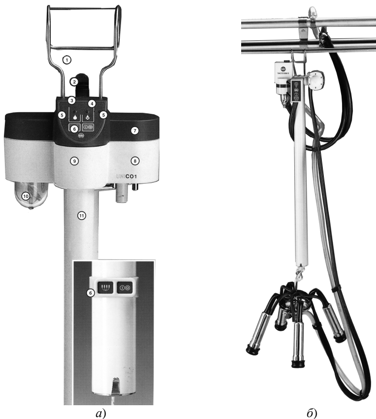
Рис. 4.16. Доильные аппараты фирмы SAC: а – "UNICO1"; б – "SACCO 800S";
