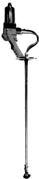
Рис. 4.17. Арматура ДПг-4М для погружного размещения электродов в анализируемой среде
