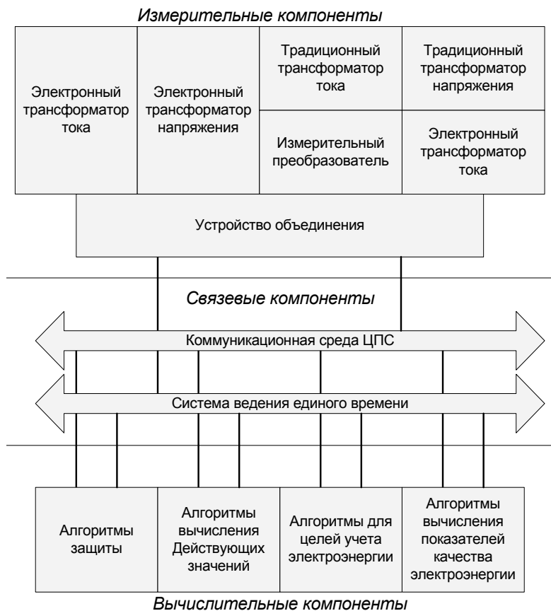
Рис. 5.2. Структура измерительной системы (ИС) ЦПС
