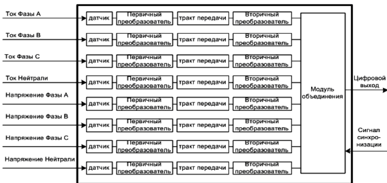
Рис. 2.2. Общая функциональная схема измерительных трансформаторов с цифровым выходом
