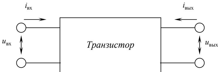
**Рис. 41. Представление биполярного транзистора четырёхполюсником**
