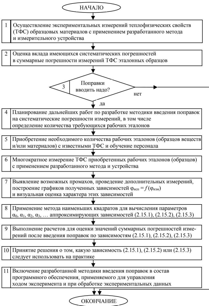
Рис. 2.3. Процедура разработки методики введения поправок на систематические погрешности измерения теплофизических свойств веществ
