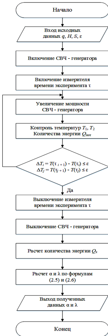
Рис. 2.2. Блок-схема работы микропроцессорной ИИС разработанного микроволнового метода контроля ТФХ материалов и изделий с односторонним нагревом
