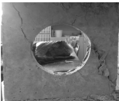
Рис. 3.45. Картина трещин при разрушении неармированных моделей с проемами: a – оконными квадратными; б – дверными; в – оконными круглыми
