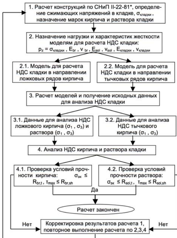
Рис. 1.33. Блок-схема расчета каменных конструкций с учетом НДС кладки
