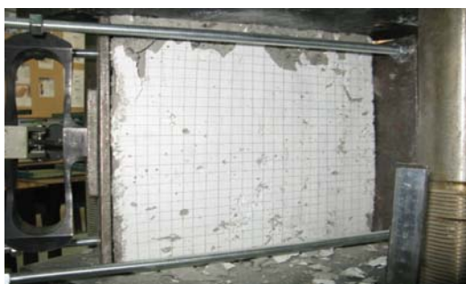
Рис. 3.32. Механизм деформирования модели стен при F_x = 3 кН и F_z (кН): 90, 126, 131 (разрушение)
