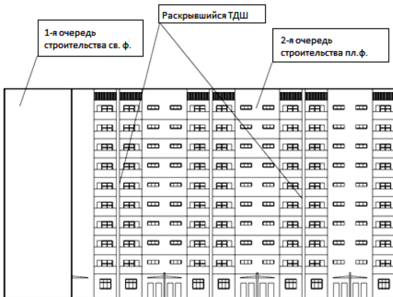
Рис. 4.5. Дворовый фасад: св. ф. – свайный фундамент; пл. ф. – плитный фундамент; ТДШ – температурно-деформационный шов
